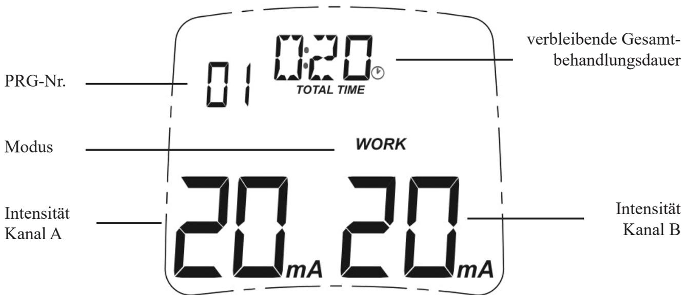
In der unteren Reihe kann man nun die Intensität in mA für jeden Kanal getrennt ablesen. Durch wiederholtes Drücken der „+” Taste/n wird die Stimulationsintensität erhöht. Durch wiederholtes Drücken der „-” Taste/n wird die Stimulationsintensität reduziert. Die Intensität sollte so eingestellt werden, dass der Strom deutlich zu spüren ist, aber in jedem Fall unter der Schmerzgrenze bleibt.
